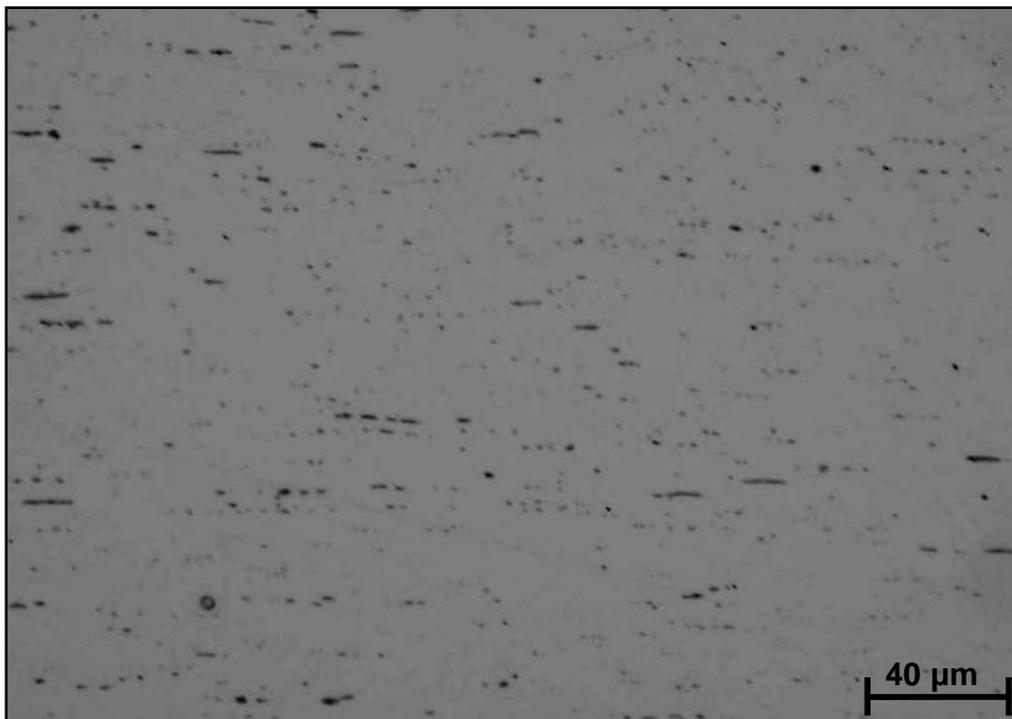
Figura 6 – Inclusões não metálicas observadas em microscópio óptico.
