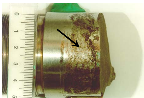
Figura 3. Desgaste verificado na superfície do eixo fraturado, na região de acoplamento com o disco de apoio. A coloração marrom avermelhada exibida na superfície de contato entre as partes é típica de frete em ligas metálicas ferrosas.
