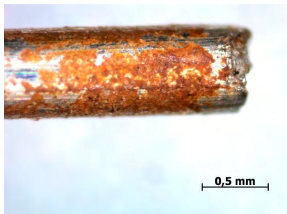
**Figura 2.** Modo de fratura plana precedida de pouca deformação plástica e corrosão ao longo da superfície de um segmento do arame.
