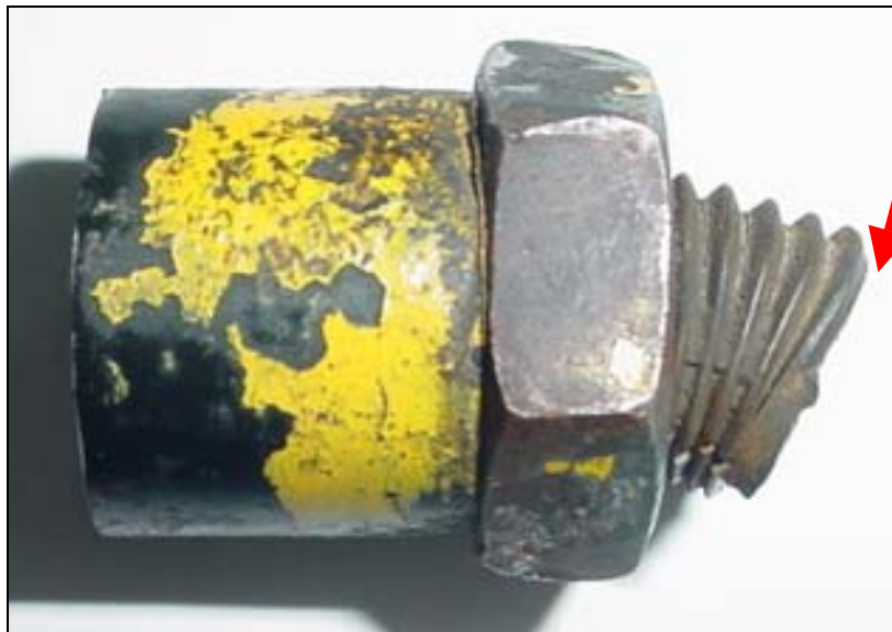
Figura 5 – Imagem em câmera digital mostrando extensa deformação plástica do componente. A seta vermelha indica o local de início da falha
