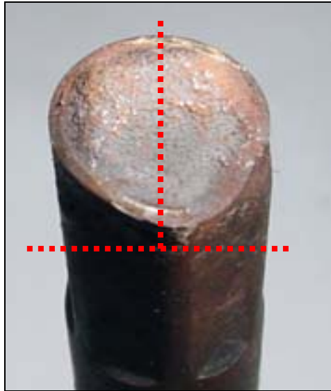
Figura 3 – Imagem em lupa de baixo aumento apresentando o local onde a amostra foi retirada para análise metalográfica.
