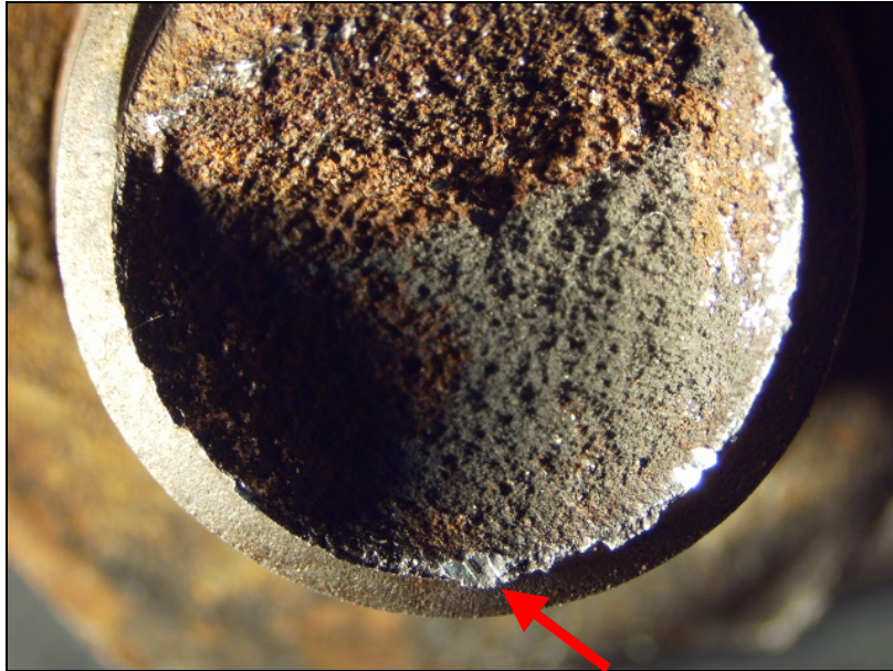
Figura 4 – Imagem em lupa de baixo aumento mostrando a região da falha. A seta indica o início da fratura.
