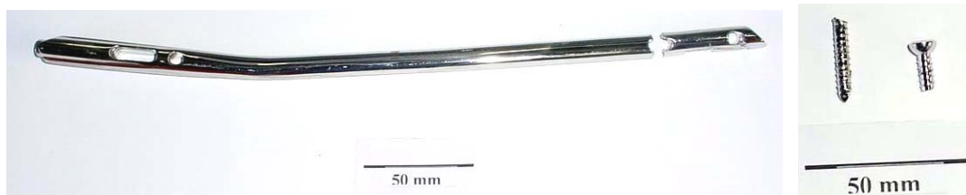
Figura 1: Conjunto de prótese intramedular fraturado.
