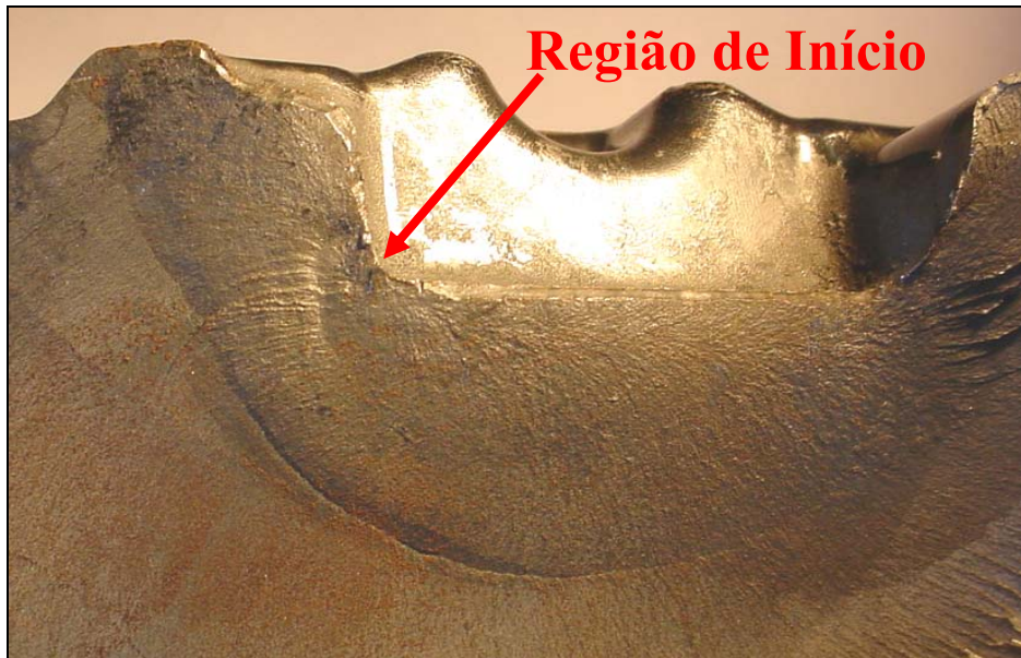
Figura 3. Imagem mostrando a superfície de fratura da matriz. Em detalhe a região de início da falha.
