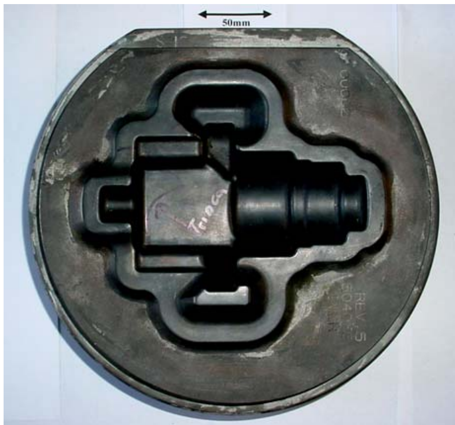
Figura 1. Imagem mostrando a matriz de forjamento que falhou em serviço.
