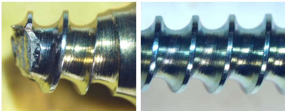
Figura 2. Marcas de usinagem nos filetes do parafuso.
