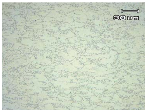
Figura 5 – Micrografias do parafuso mostrando a microestrutura composta por grãos grãos \alpha + \beta globular.
