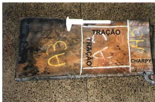
**Figura 3.** Posicionamento e orientação dos corpos de prova retirados para a realização dos ensaios mecânicos.
