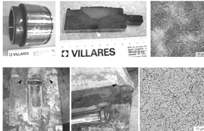
Figura 5: Diversas falhas em matrizes, devido à dureza excessivamente alta. (3)
