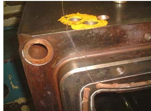
Figura 1. Trinca que atravessou a parede do molde de VP20ISO.
