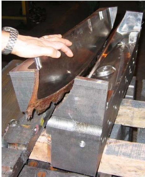
Figura 3. Exposição das faces de fratura, após recorte do molde.
