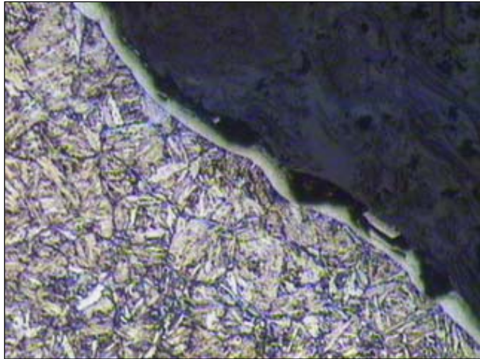
Figura 6. Detalhe de região da superfície apresentando irregularidades na camada branca da nitretação e deslocamentos. Ataque: Nital 4%. Aumento:200x.
