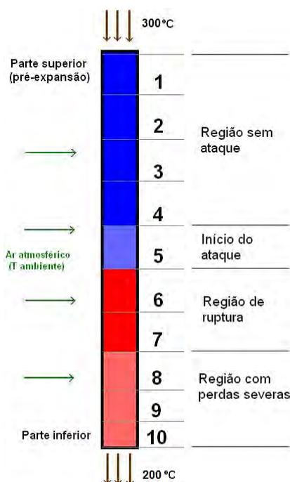
Figura 8. Esquema do ataque corrosivo no tubo.
