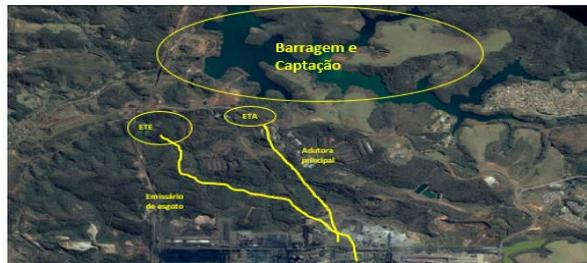
Figura 2. Barragem, Captação, ETA e condução da água até a usina
