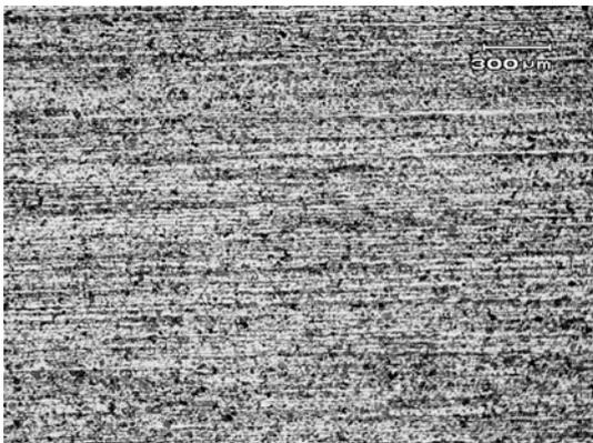
Figura 2 - Fio Máquina aspecto longitudinal da amostra caracterizando o sentido de trefilação, estrutura perlítica (região escura) e ferrita (região clara), ataque Nital 2% Aumento:50X.
