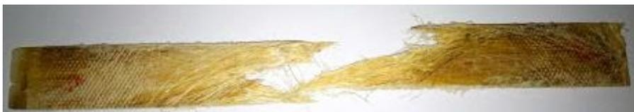
Figura 4: Aspecto macroscópico da fratura apresentado pelos corpos de prova estudados nesse trabalho.
