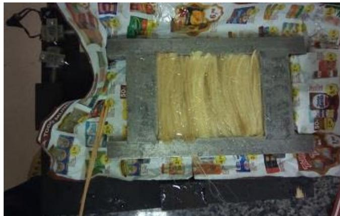
Figura 2: Fibras de curauá sendo postas no molde juntamente com a resina para a confecção das placas de compósito.
