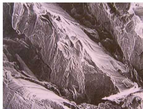
Figura 2. b) foto da superfície do cavaco de GG-25 usinado a 750 m/min
