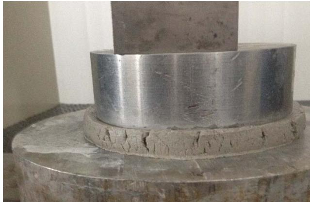
**Figura 2.** Fissurações em argamassas no estado fluido.
