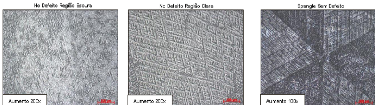
Figura 8. Análise metalográfica das amostras com e sem defeito
