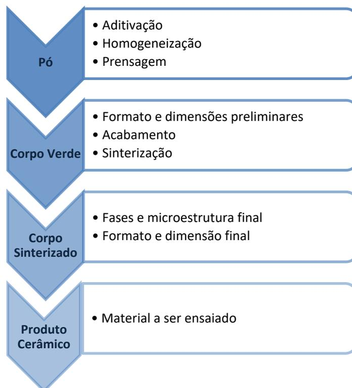
Figura 2 - Fluxograma do processamento cerâmico.
