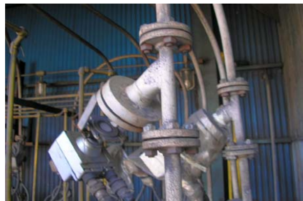
Figura 1. (A) Detector monostático; e (B) Granulflow no distribuidor.
