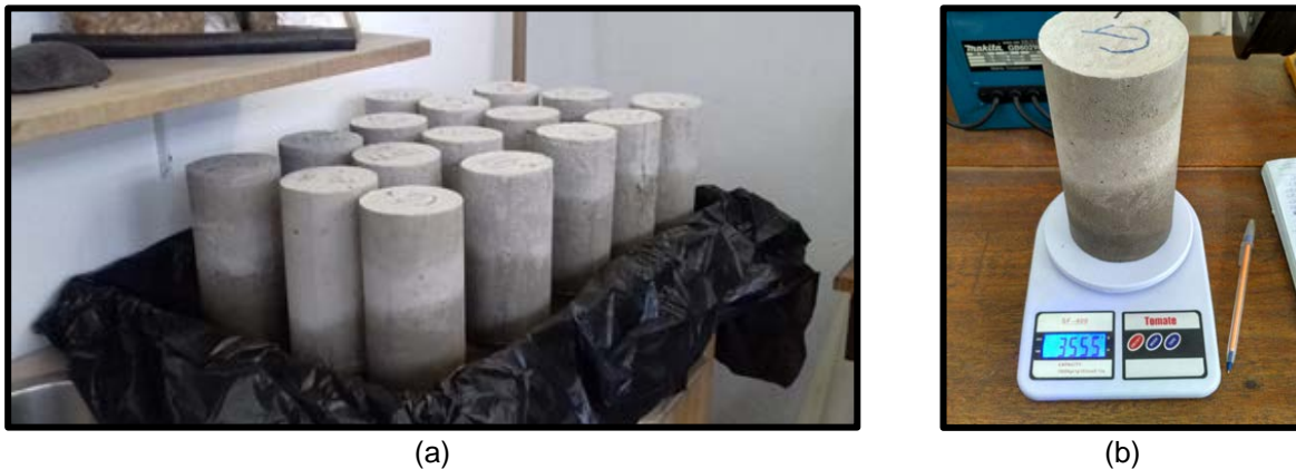
Figura 3. (a) Aspecto dos corpos de prova após 24 horas em contato com a água. (b) Aferição da massa de um dos CPs após 24 horas em contato com a água.
