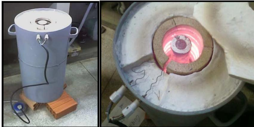
Figura 2. Forno vertical refrigerado a água utilizado no processo de solidificação.
