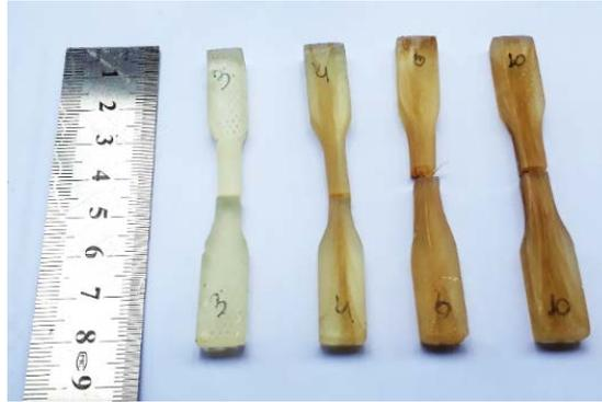
**Figura 3.** Aspecto macroscópico da fratura dos compósitos ensaiados em tração.
