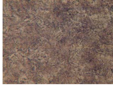
Figura 15 - ferrita, agregados e martensita: Aumento 500X
