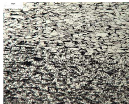
Figura 7 – ferrita e perlita esboroadada: Aumento 200X
