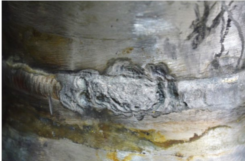
Figura 1. Perfurações provocadas por corrosão na solda de emenda de tubo em AISD.
