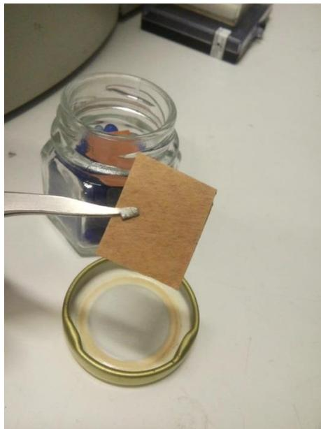
Figura 2:Membrana de Fibroína obtida pelo método reverso pós-liofilização
