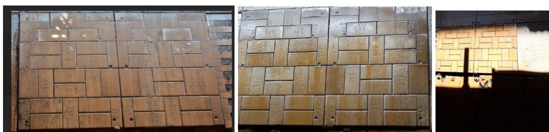
Figura 11 – Status das chapas de desgaste em um período de 01 ano de teste.
