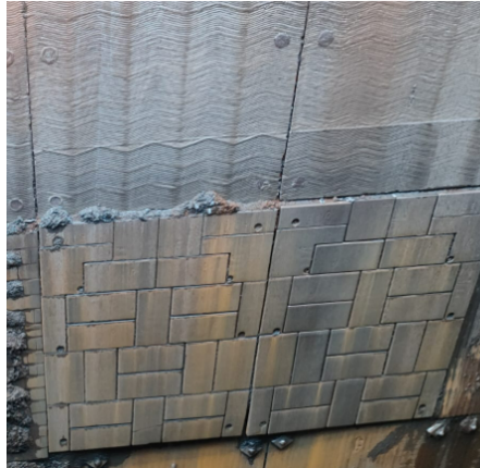
Figura 12 – Status das chapas de desgaste em um período de 02 anos de teste.
