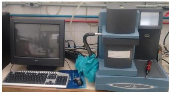
Figura 3. Equipamento DMA Q800 – TA Instruments.
