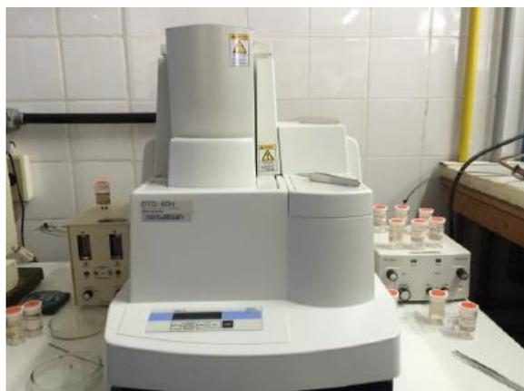
**Figura 2.** Equipamento Shimadzu modelo DTG-60H.
