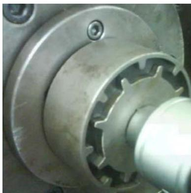
Figura 6. Montagem com acoplamento polimérico.
