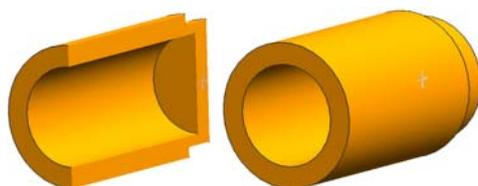
Figura 2. Blank bruto injetado do acoplamento.
