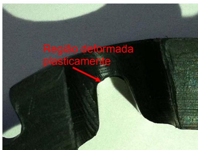
Figura 15. Imagem do acoplamento polimérico após ensaio de torção.
