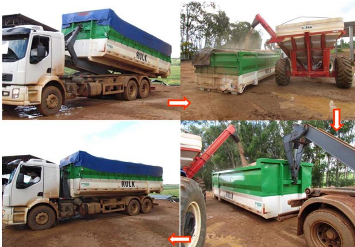
**Figura 1.** Caminhões do tipo Roll On – Roll Off recolhendo os containers carregados a serem transportados para os silos.
