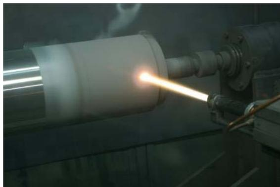
**Figura 4.** Processo de revestimento
