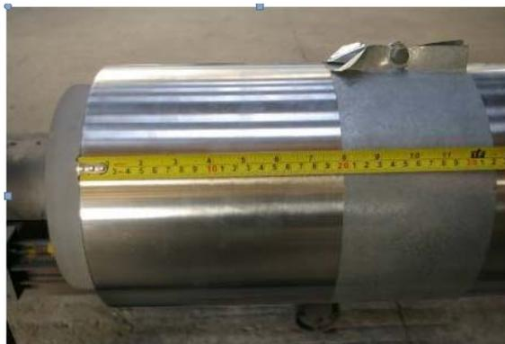
**Figura 3.** Preparação da área a ser revestida
