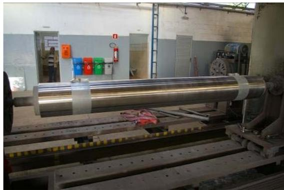
**Figura 2.** Preparação do rolo para o processo de revestimento
