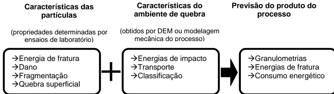
**Figura 1.** Esquema representativo do Modelo Generalizado da Cominuição (MGC).
