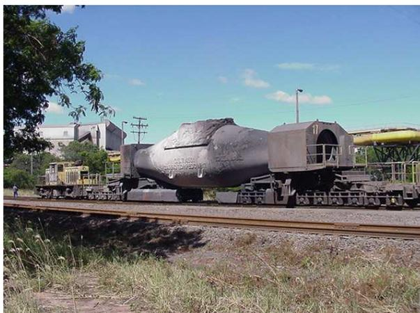
**Figura 1** – Carro Torpedo e locomotiva.
