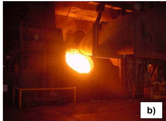
Figura 5. a) Carepa tratada e armazenada em tambores que serão enviados para a aciaria da VMB. b) Carregamento de sucata no conversor LD da VMB.
