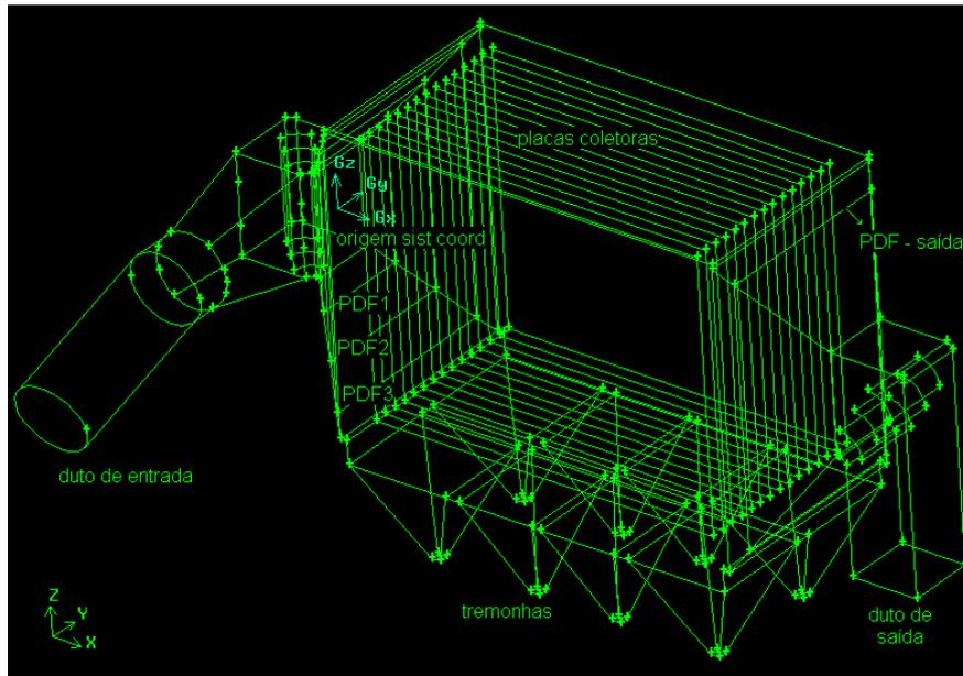
Figura 1: Domínio de cálculo para o precipitador eletrostático.
