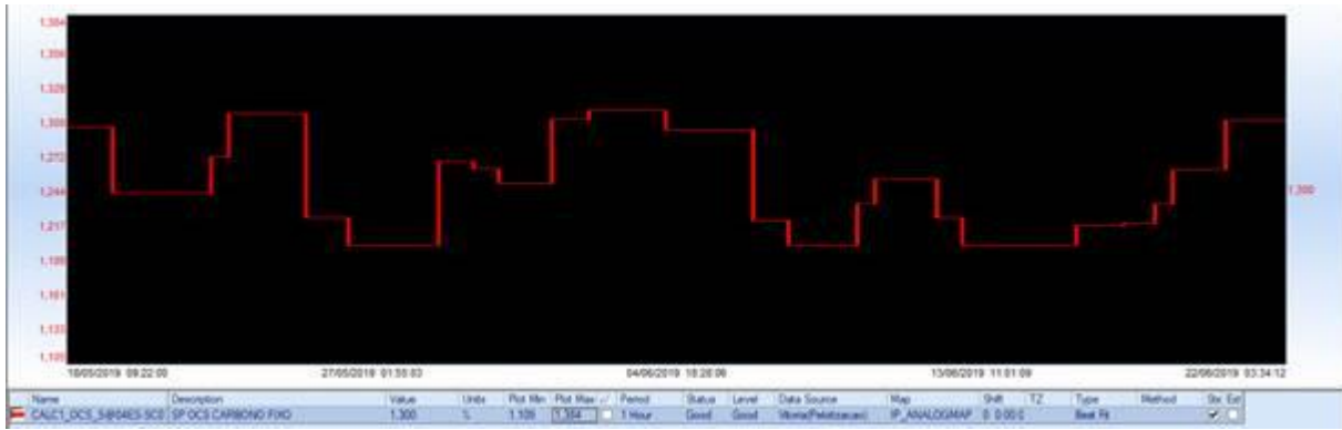
Figura 5. Tela do PIMS mostrando o registro do setpoint aplicado pelo OCS.
