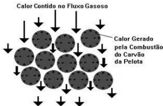
Figura 1. Transferência de calor do fluxo gasoso para o leito de pelotas na zona de queima. [1].
