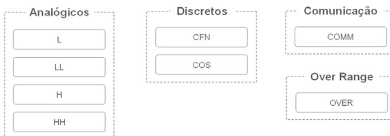
**Figura 8.** Diagrama de afinidades dos tipos de alarmes gerados nos sistemas de controle.
