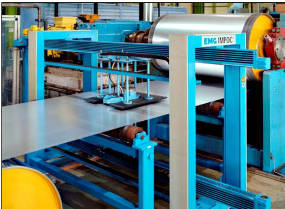
Figura 1: EMG-IMPOC; Instalação numa CGL.
