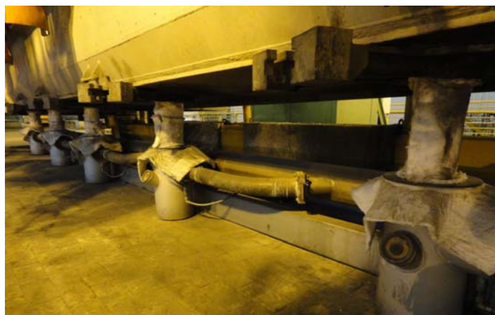
Figura 1. Esquema de aquecimento das válvulas submersas pelo Venturi 6 e foto do sistema da VSB.
