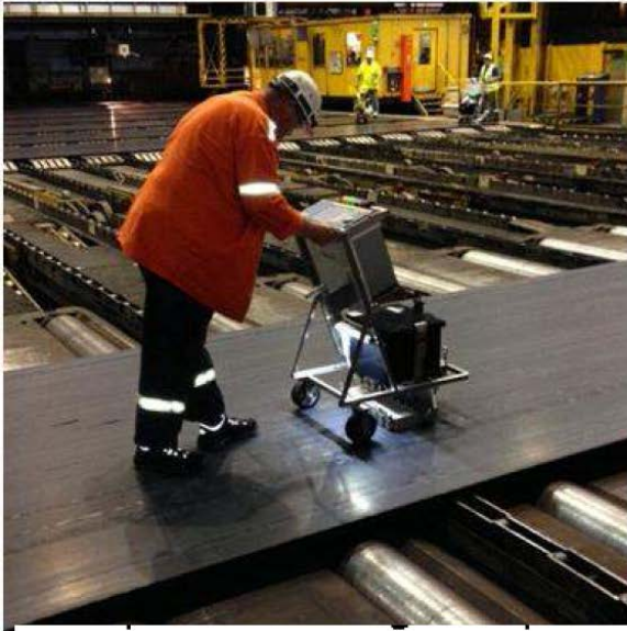
Figura 4: Inspeção de chapas grossas na Dillinger para detecção de eventuais hard spots [14].
