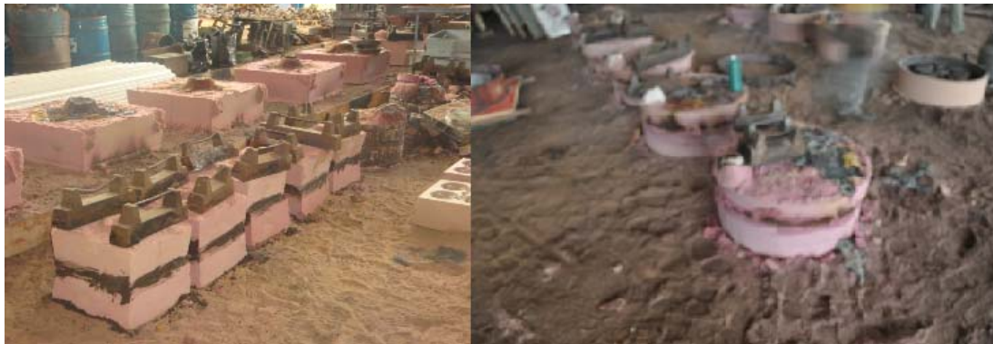
Figura 1 - À esquerda os moldes retangulares substituídos pelos moldes redondos à direita. 5)
