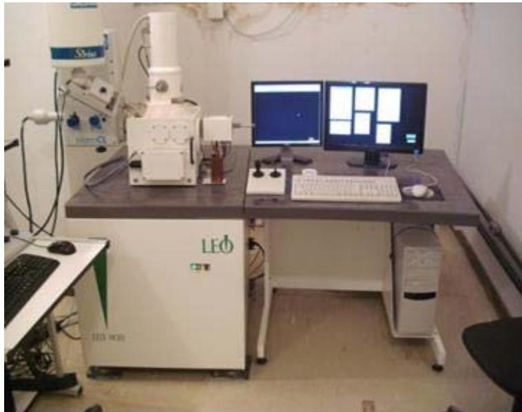
**Figura 4:** Equipamento de microscopia eletrônica de varredura (MEV)
