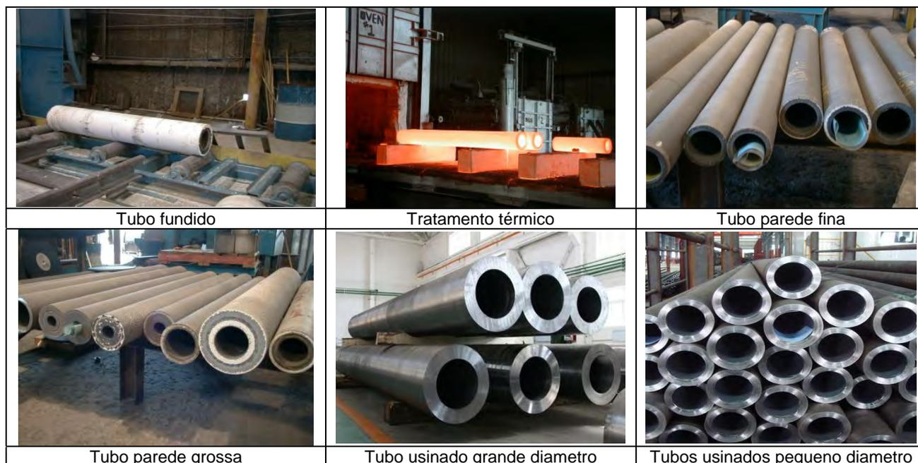
**Figura 5.** Fabricação de tubos centrifugados.
