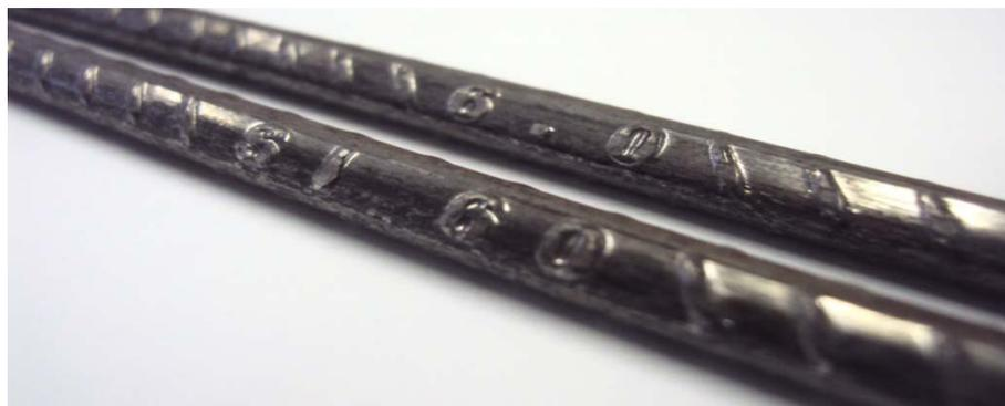
Figura 11: Amostra de CA60 5,0mm com alta camada residual de sabão.
