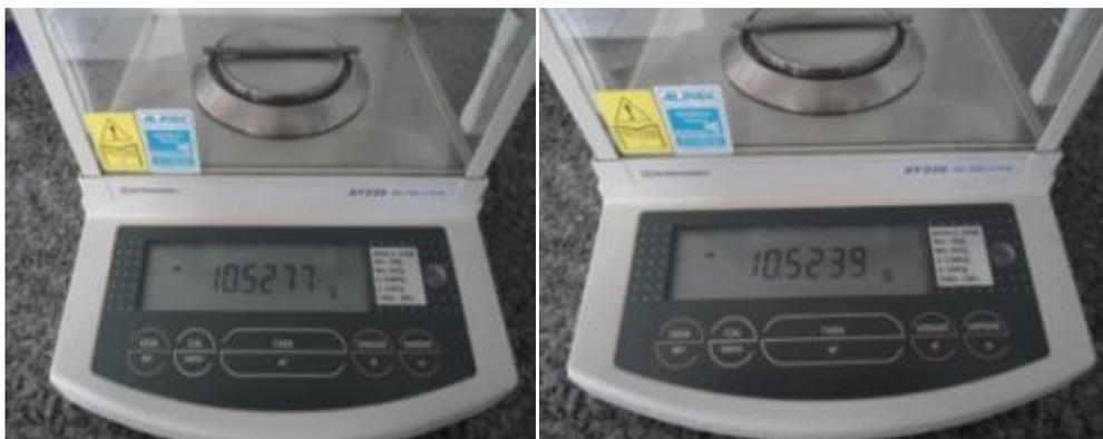
**Figura 3:** Pesagem do arame (a) antes da imersão, (b) após a imersão.
