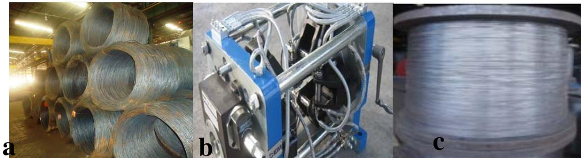
**Figura 1:** (a) Fio máquina, (b) K7 para redução do arame e (c) Amostra de CA60 em carretel.
