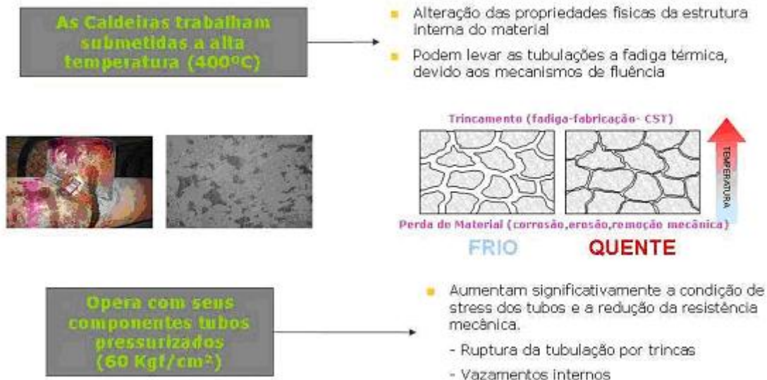
Figura 7. Mecanismo de falha das caldeiras.
