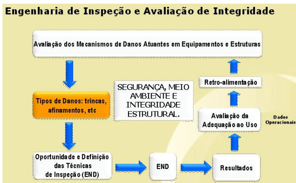
Figura 8. Fluxograma da avaliação dos mecanismo de falha.
