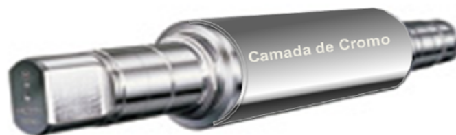
Figura 6 – Representação da camada de cromo aplicada no cilindro de trabalho.
