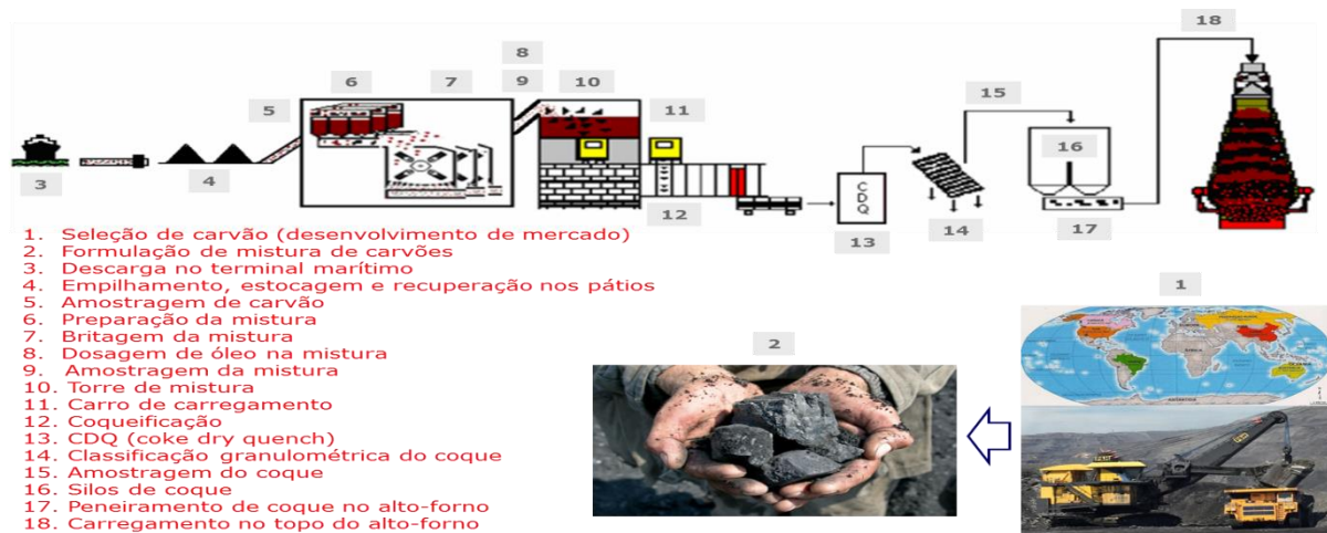
Figura 7 – Mapa de processo produção de coque na AMT
