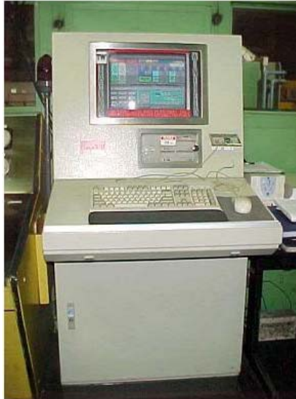
Figura 6. Compuweld armazena todos os parâmetros de soldagem.
