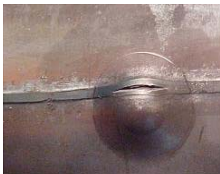
Figura 4. Ensaio de embutimento confirmando a má qualidade da solda de LDC.
