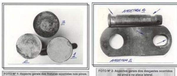
FOTO Nº 1-Aspecto geral das fraturas ocorridas nos pinos.
