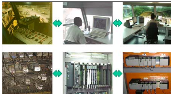
Figura 20 – Fases da Automação do Virador de Vagões
