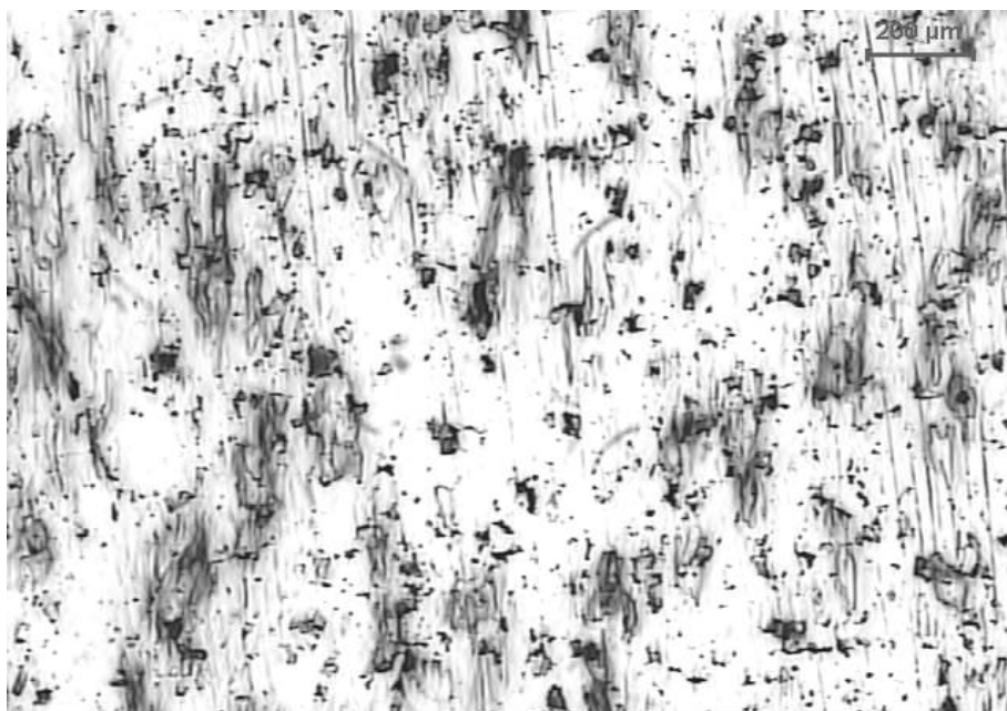
Figura 2 – Micrografia de CI78I polido após uso com presença de riscos e arrancamentos
