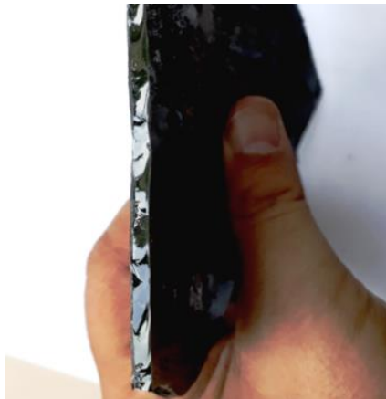
Figura 6. Exemplo de um filme de escória do pó fluxante 1 ajustado evidenciando a região da fratura, à direita. Espessuras dos filmes de escórias solidificadas de pós fluxantes, à esquerda.
